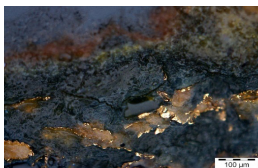
Figura 15- Inferior dcha. Impregnación de aceites y resinas en las muestras lo que dificulta la identificación de los estratos originales y los añadidos en épocas posteriores
