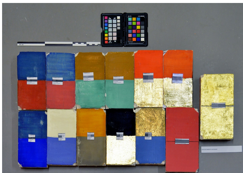
Figura 23- Probetas tipo identificativas de los materiales modernos e históricos empleadas para el ensayo.
